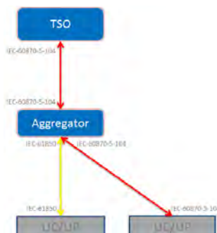
Figura 19 Schema di valutazione del traffico dati associato agli standard IEC-61850 e IEC 60870-5-104
